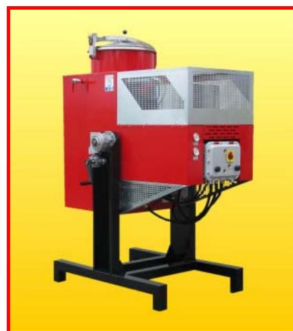
Выпаривание загрязненного растворителя происходит внутри бака из нержавеющей стали AISI 304, помещенного в оболочку, наполненную диатермическим маслом, которое нагревается нагревательным резистором. Образовавшиеся пары проходят через конденсор, который охлаждается воздухом или водой. Полученный таким образом растворитель собирается в сосуде и готов к дальнейшему использованию.
